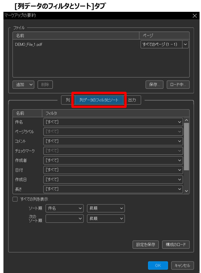
要約に出力する各列データのフィルタ、ソートを設定します ※Core プランではフィルタ、ソートの設定はできません。
